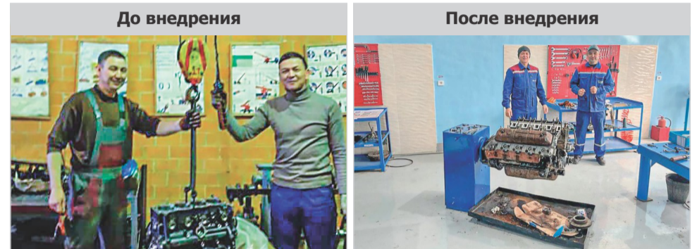
Рисунок №5. Идея приобрести кантователь для двигателя. Длительность ремонта ДВС сократился в 1,5-раза. За счет исключения лишних движений и транспортировок.
