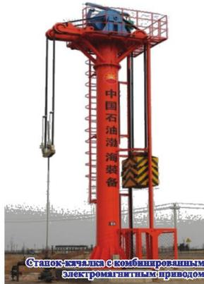
Станок-кчалка с комбинированным электромагнитным приводом
